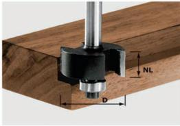
Falztiefe kann durch Tauschen der Kugellager auf 4,9 mm, 6,36 mm, 7,9 mm und 11 mm erweitert werden
