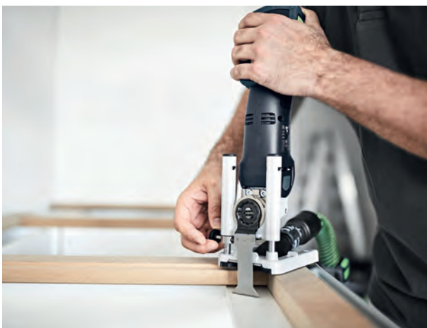
Ausklinkungen, Ausschnitte und Eintauchschnitte gelingen dank praktischer Ansetzhilfe
