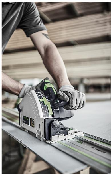
Ausriffsfreier Schnitt: Festool Führungsschienen verbessern die Handhabung
