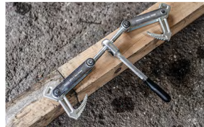
Ideales Werkzeug zum Spannen, Ziehen und Pressen von Holzbalken
