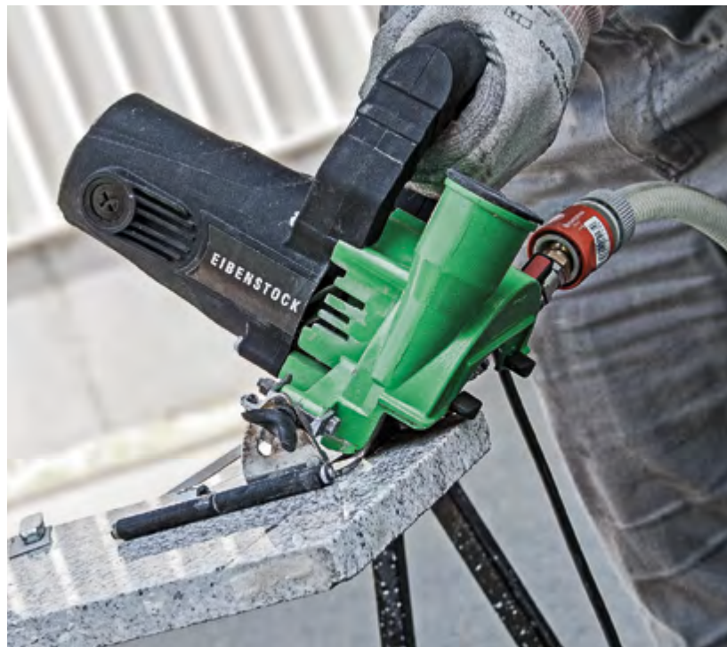
Perfekt zum Schneiden von Steinplatten, zum Beispiel aus Naturstein und Feinsteinzeug
