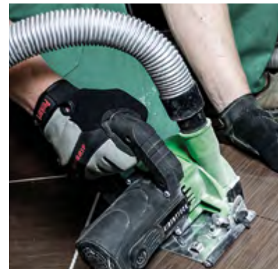
Schlitten mit Rollenführung schonen Werkstückoberflächen
