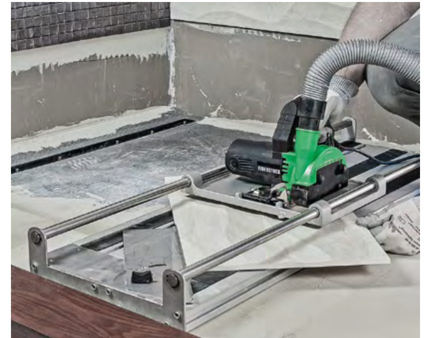
Verstellbarer Seitenanschlag für Diagonalschnitte bis 45 Grad
