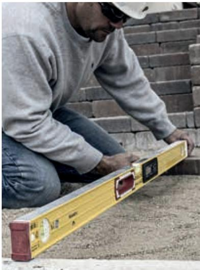
Dank akustischer Zielführung lassen sich Bauteile schnell ausrichten
