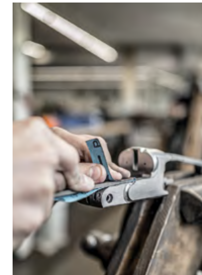
Metall: Hier wird die Basküle einer Doppelflinte händisch für den Einbau vorbereitet
