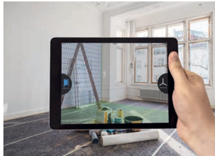
Grundrisse einfach mithilfe der Kamera eines Tablets erstellen
