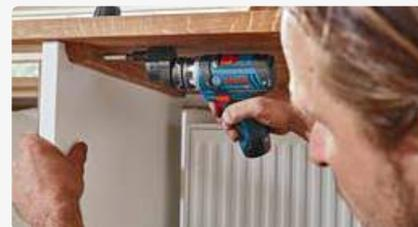
Sehr randnah Schrauben lässt sich mit dem Exzenteraufsatz. Wie beim Winkelaufsatz ist seine Position in 16 Stufen einstellbar.
