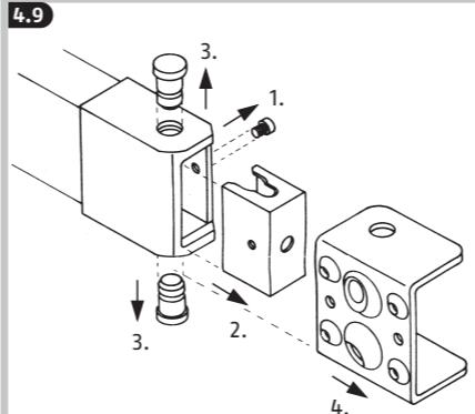
**(DE)** Bandseitenbefestigung in der angegebenen Reihenfolge zerlegen
