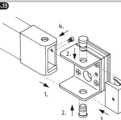
**(DE)** Bandseitenbefestigung in der angegebenen Reihenfolge komplettieren
