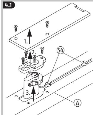
**(DE)** Zylinder in angegebener Reihenfolge ausbauen. Anschlagschrauben **54** eine Umdrehung lösen.
