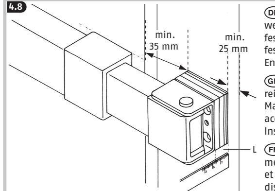
**(DE)** Montage der Bandseite: Das Riegelrohr ist beweglich und kann ggf. komplett herausgezogen werden. Panzerriegel mit ausgeschlossenem Riegel in gewünschter Höhe anhalten und Bandseitenbefestigung anzeichnen. Darauf achten, dass die Verankerung im Mauerwerk erfolgt, ggf. Bandseitenbefestigung entsprechend verschieben. Abstand zwischen Gelenkplatte und Wand messen (L). Entsprechende Anzahl Unterlegscheiben einsetzen.
