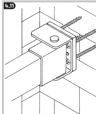
**(DE)** Türfunktion prüfen! Eventuell separaten Türstopper montieren. Bei Stumpftüren und / oder Montage im engen Nischenbereich 6 mm-Unterlage verwenden
