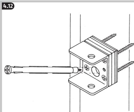
**(DE)** Zur stabileren Befestigung der Gelenkplatte Ø 10 mm und ca. 140 mm tief in Senkungsrichtung schräg ins Mauerwerk bohren. Dübel komplett mit Schrauben einsetzen und festschrauben
