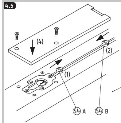
**(DE)** Schraube S4 A bei abgezogenem Schlüssel bis zum Anschlag schieben und festdrehen (1). Riegel durch eine Schlüsseldrehung ausschließen und Schlüssel wieder abziehen. Anschlagschraube S4 B in Pfeilrichtung bis zum 1. Widerstand schieben und festdrehen (2). Achtung: Federwiderstand nicht überwinden (3). Abdeckplatte anschrauben (4) bzw. mit 4.6 fortfahren.
