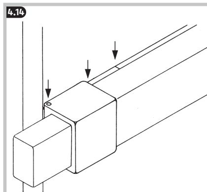
**(DE)** Riegel ausschließen, Schlosskörper waagerecht ausrichten und bündig mit der Türkante anzeichnen
