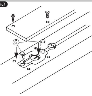
**(DE)** Abdeckplatte auf der Rückseite des Panzerriegels abschrauben und Aufbohrschutzstopfen G mit leichten Hammerschlägen einsetzen.
