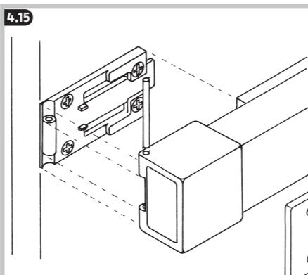
**(DE)** Montageplatte abnehmen. Bohrungen anzeichnen, vorbohren (Holz Ø 3,5 mm, Metall Ø 4,0 mm) und Platte festschrauben. Bei Stumpftüren Unterlegplatte verwenden. Schlosskörper auf die Montageplatte drücken und Gelenkstift eindrücken
