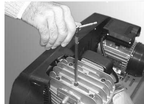
Zylinderkopfschrauben nach der 1. Arbeitsstunde kontrollieren eventuell nachziehen.
