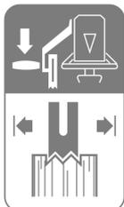
3. **17** Håll den vänstra betjäningsspaken (12) nedtryckt och tryck halvvägs ned den högra betjäningsspaken (13), för att först klyva stammen långsamt.
