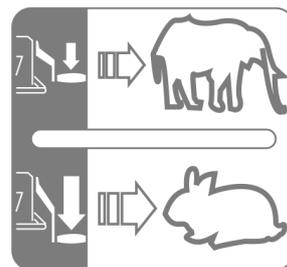
Nagy hasítási sebesség, kisebb hasítóerővel a normál tuskók hasításához, illetve a hasítási művelet végén → a kezelőkar alsó állásban van.
