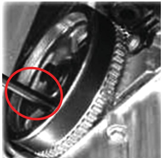
Hinweis: Kettenspanner kann mit einem passenden Bohrer in eingefahrener Position gehalten werden
