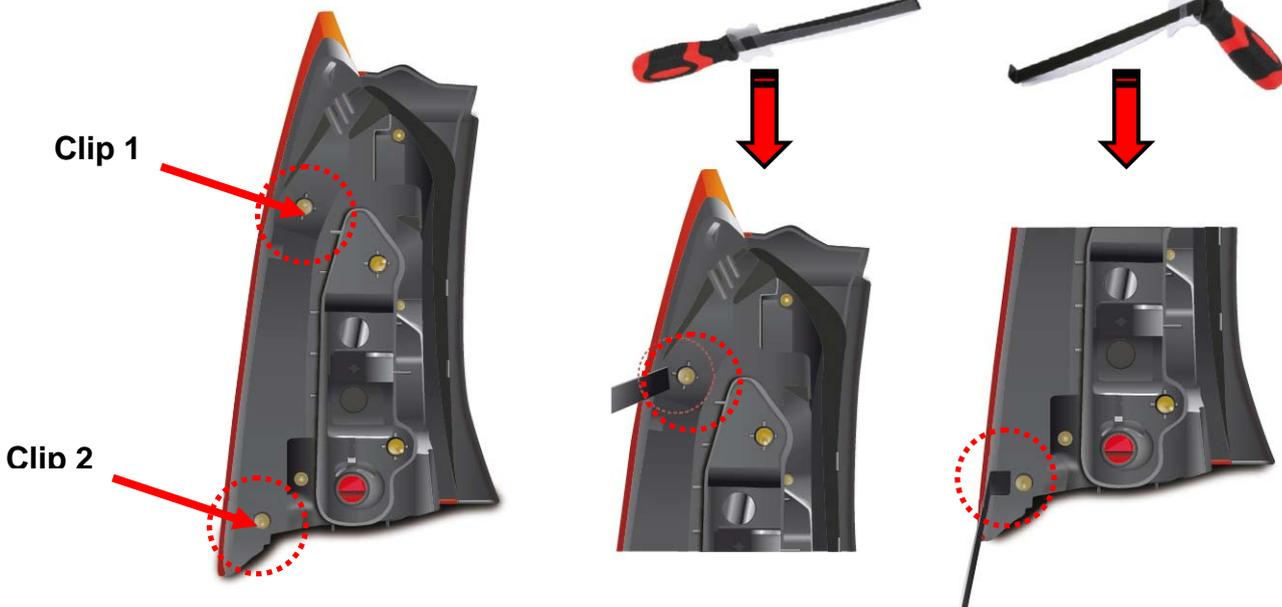
Clip 1 kann mit geradem Werkzeug demontiert werden
