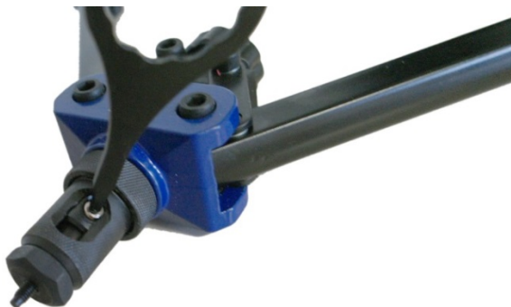
Hebelarme spreizen und Haltebolzen herausdrücken
