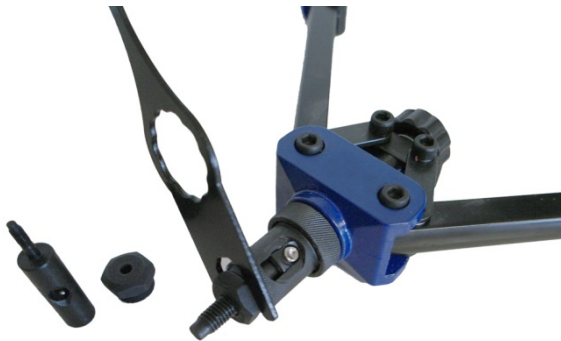
Überwurfmutter mit Schlüssel lösen
