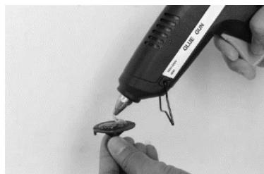
Den Klebe-Pad genau und schnell auf der Oberfläche des Dellen-Bereichs pressen.
