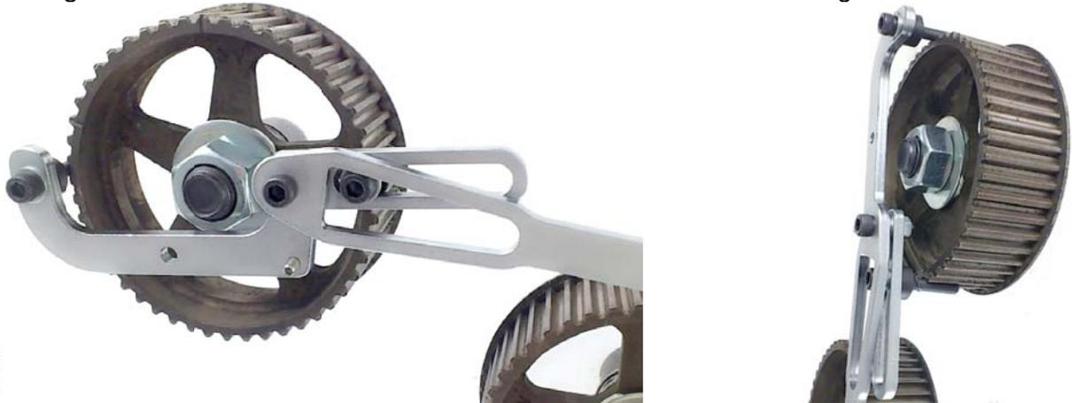
Gegenhalteschlüssel beim Lösen oder Festziehen mit der Hand halten oder wenn möglich wie in der Abbildung zu sehen auf dem zweitem Nockenwellenrad abstützen
