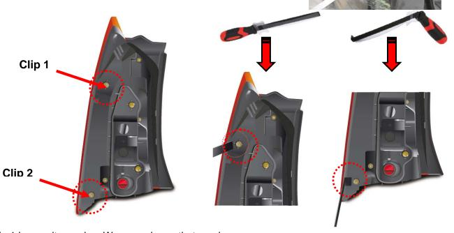
Clip 1 kann mit geradem Werzeug demontiert werden Clip 1 could be removed by the straight remover.
