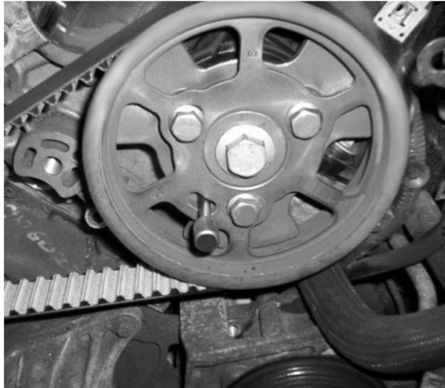
*LR/Jaguar 3.0 TDV6 und PSA 2.7/3.0D HDi* - Stecken Sie 1 x Nockenwellen-Arretierstift (D) in die/das linksseitige Nockenwelle/Zahnrad (Abb. 8) und den anderen Nockenwellen-Arretierstift (D) in die/das rechtsseitige Nockenwelle/Zahnrad. (Abb. 9)
