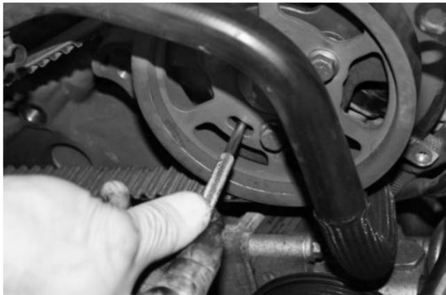
**HINWEIS:** Der Verweis auf linksseitige oder rechtsseitige Nockenwelle geht davon aus, dass man direkt auf die Nockenwellenräder schaut. Überprüfen Sie, dass sich der Riemenspanner in der richtigen Position befindet. Diese ist gewährleistet, wenn die Markierung (Gehäusemarkierung) auf dem Riemenspanner durch die Aussparung sichtbar ist.
