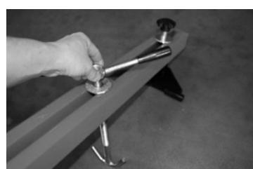
Posizionare il supporto motore con il sostegno o sul bordo di avvitamento del paraurti o piuttosto sul bordo saldato del paraurti. Assicurarsi che entrambe le viti di allineamento chiuse manualmente siano serrate.
