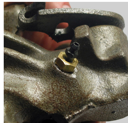
Die Bremsanlage kann jetzt wieder über das neue Ventil entlüftet werden.
