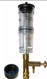
**3 Umbau für Test mit fahrzeugspezifischen Adapter**
