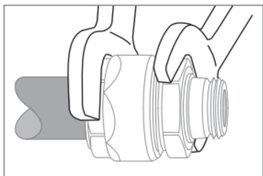
4. Überwurfmutter festdrehen, Verschraubung beim Festdrehen gegenhalten
