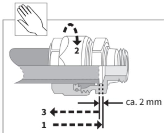
1. Rohr bis zum Anschlag einschieben
