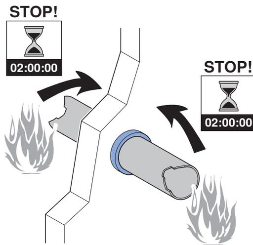
Das vorliegende Geberit Rohrschott120 ist ausschliesslich für den Einsatz mit Geberit Silent-db20 oder Geberit PE Rohrleitungen bestimmt.
