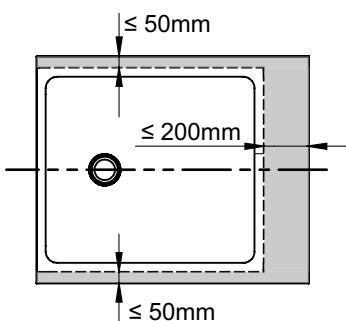
**DE** Mögliche Schnittbereiche. Achtung: Maße von bauseitigen Schallschutz und Abdichtungsbändern sind bei der Bestimmung der Schneidmaße zu beachten
