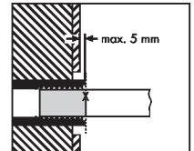
①取付アダプターの接続スレッドを下図寸法 (Xmm) に切断してください。
