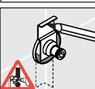
③取付金具を用いて取付穴を印してください。
