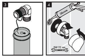
②ニップルエルボにパッキンを取り付け、工具（径 22mm）にて締め付けてください。
