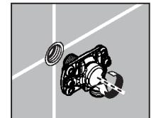
②取付アダプターを用いて取付穴を印してください。
