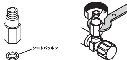
ホースおよび逆流防止弁付アダプターが共回りすることないように、必ずホースナット付根を工具で固定しながら、ホースのナットを締め付けてください。
