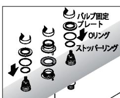
ストップアーリングを取り付面の浴槽リム上部より、それぞれ左右のバルブハウジングの切り欠きに合わせて取り付けます。O-リングをそれぞれのバルブ固定プレートに取り付けて、ストップアーリングにあたるまで確実にねじ込みます。中央のスパウトハウジングには、浴槽リム上部よりスパウト受け金具とシートバッキンを奥まで取付けます。スパウト受け金具の固定ピンを、浴槽リムの穴に必ず通してください。吐水口ゆるみの原因になります。
