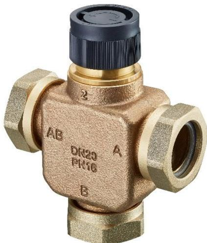
Das Tri CTR ist ein Dreiwegeventil, welches als Verteil- oder Mischventil verwendbar ist. Für den Einsatz als Verteilventil hat das Tri CTR einen Eingang (AB) und zwei Ausgänge (A und B). Das durchfließende Medium wird je nach Stellung des Ventileinsatzes von einem auf den anderen Ausgang umgelenkt.
