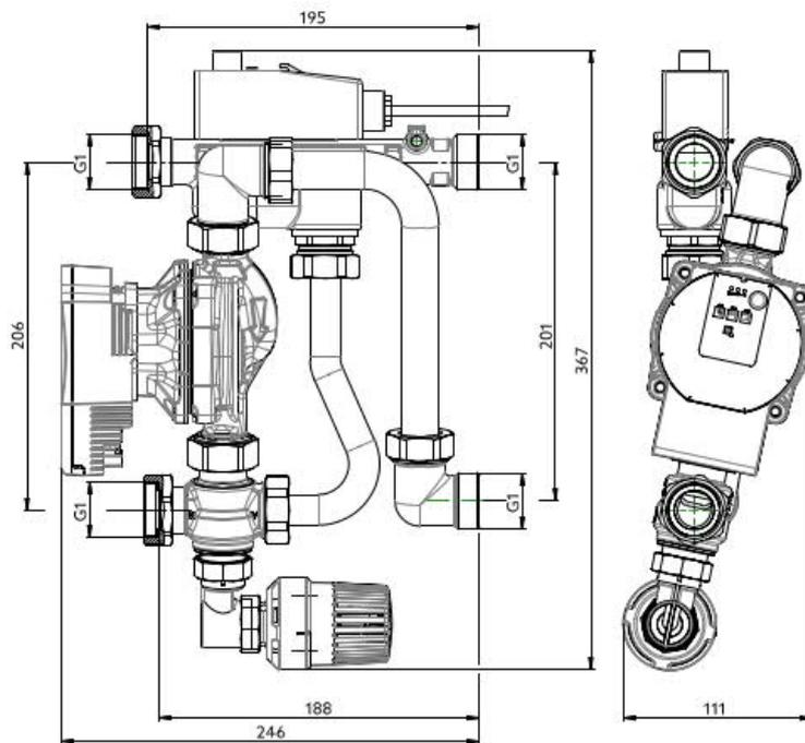
Die Bautiefe der Regelstation innerhalb des Einbauschranks beträgt ca. 111 mm von der Vorderkante Pumpengehäuse bis zur Rückwand des Einbauschranks. Hierbei sind die Befestigungsschienen bereits berücksichtigt.
