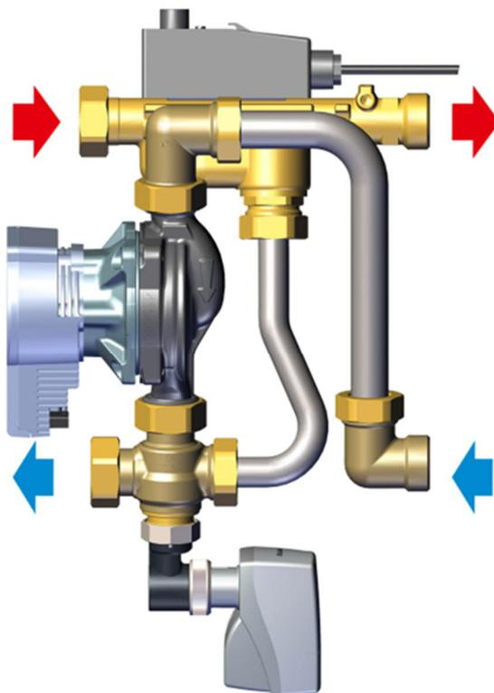
Bei der Montage der Regelstation an den Heizkreisverteiler ist die richtige Durchflussrichtung zu beachten. Der Vorlauf der Regelstation liegt immer oben. Der Rücklauf der Regelstation liegt entsprechend immer unten. Werksseitig ist die Regelstation für den Linksanschluss vorgesehen. (Verteiler rechts, siehe Abb.). Der Rechtsanschluss ist möglich und in der Bedienungsanleitung beschrieben.
