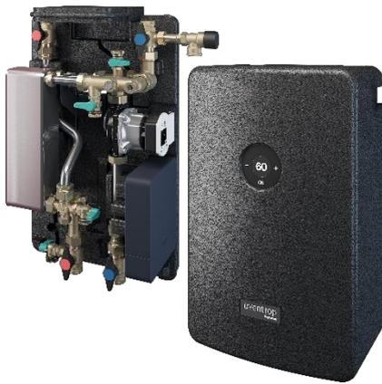
Die Regumaq X-45 Frischwasserstation ist eine elektronisch geregelte Armaturengruppe mit Wärmeübertrager zur hygienischen Trinkwassererwärmung nach dem Durchlaufprinzip zum Anschluss an einen Pufferspeicher. Abhängig von der Temperatur und dem Volumenstrom auf der Trinkwasserseite wird die Umwälzpumpe auf der Heizungsseite drehzahl geregelt. Bei der Auswahl der Frischwasserstation ist es notwendig die Wasserqualität des Einsatzgebietes zu beachten.
