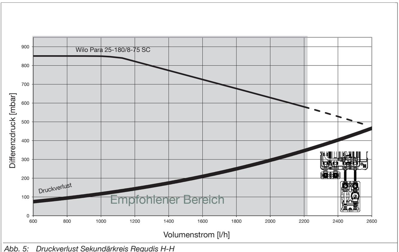
Abb. 5: Druckverlust Sekundärkreis Regudis H-H
