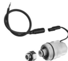
Bistabiles Magnetventil 6 V zur thermischen Desinfektion mit SCHELL Wassermanagement-System SWS. Magnetventil kann in vorgesehenen Anschluss der Wasserstrecke nachträglich eingesetzt werden. Funktion: Heißwasser wird im Bypass am Thermostatventil vorbeigeleitet. Ansteuerung erfolgt über SWS Bus-Extender Kabel BE-K oder SWS Bus-Extender Funk BE-F.
