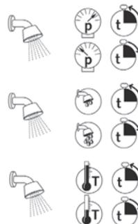
Setarea timpului de funcționare poate avea loc prin intermediul acului de reglare la o presiune de curgere de 3 bari între cca 5 și 30 s. Oscilațiile timpilor de funcționare rezultate în urma oscilațiilor de presiune din cadrul rețelei de alimentare sunt obișnuite.
