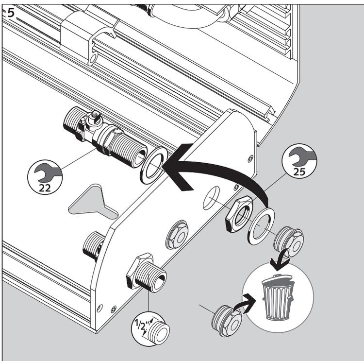
IT **Montaggio del tubo di alimentazione dall'alto**
