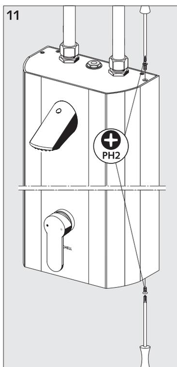
**IT Montaggio del tubo di alimentazione dall'alto**
