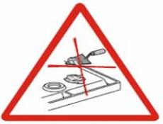
Le receveur ne doit subir aucune modification (scie, meulage de renfort...) autre que celles prévues par le fabricant.
