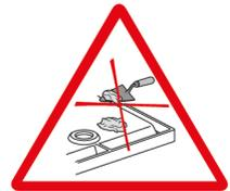
Le contact direct de plâtre ou de colle pour plaques ou carreaux de plâtre avec la sous-face du receveur est à proscrire.
