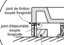
scellement ou fixation sans contact avec le receveur
