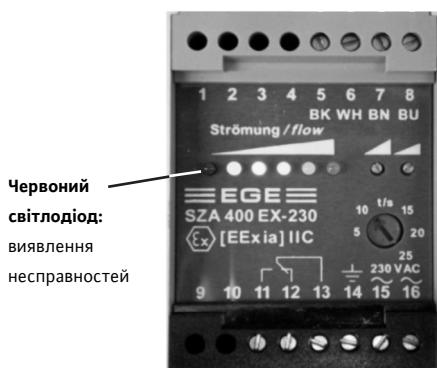
Виконайте перевірку стану безпеки. Плавно зменште витрату від номінальної до мінімальної, а потім — до нульової. Має ввімкнутись червоний світлодіод, а двигун насоса має вимкнутись після завершення часу роботи за інерцією.
