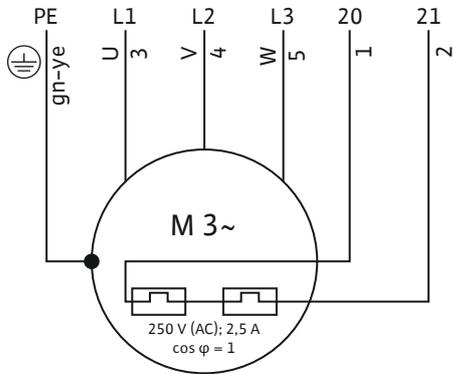
Fig. 5: Anschlussplan 3~-Motor
