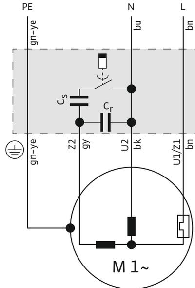
Fig. 4: Anschlussplan 1~–Motor
