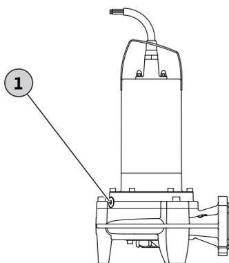
Fig. 6: Ölwechsel Dichtungskammer
