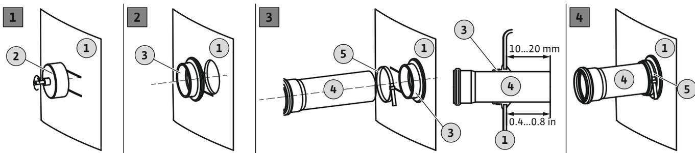
Fig. 5: Zulauf anschließen
