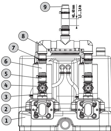
Fig. 3: Druckanschluss anbringen
