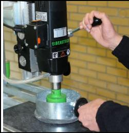
Legen Sie die zu bohrende Fliese bzw. Platte auf den Bohrtisch und richten Sie sie aus. Fixieren Sie das Werkstück mit dem Niederhalter der gleichzeitig auch Schutz gegen herumspritzendes Wasser ist.
