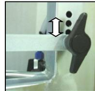
Stellen Sie die für den Bohrkronendurchmesser korrekte Drehzahl am Stellrad ein und schalten Sie die Maschine an. Richten Sie sich dabei nach den Angaben des Bohrkronenherstellers. Betätigen Sie den Geräteschalter. Die Pumpe schaltet zeitgleich mit der Maschine an. Die Wassermenge können Sie über den Minikugelhahn an der Pumpe regulieren. Beginnen Sie erst mit dem Bohren, wenn ausreichend Wasser aus der Bohrkrone austritt.
