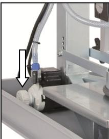
Die **EFB 152 PX** verfügt über einen Wasserkreislauf mittels Pumpe. Vor der Inbetriebnahme der Maschine ist die Auffangwanne soweit mit Wasser zu befüllen, bis der Ansaugstutzen der Pumpe vollkommen mit Wasser bedeckt ist. Nur so ist der einwandfreie Betrieb gewährleistet.
