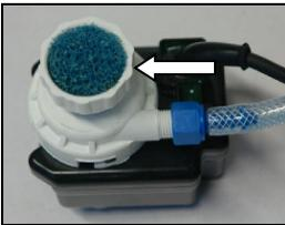
Dazu entfernen Sie die aufgesteckte Gitterabdeckung, entnehmen den Schwamm und reinigen ihn unter klarem Wasser.
