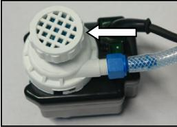
Zum Schutz der Pumpe vor verschmutztem Kühlwasser ist diese mit einem Filterschwamm ausgestattet.
