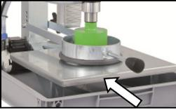
Für Bohrungen bis zu einem Durchmesser von 40 mm verwenden Sie die Abdeckplatte. Für Bohrungen größer 40 mm ist diese unbedingt zu entnehmen.
