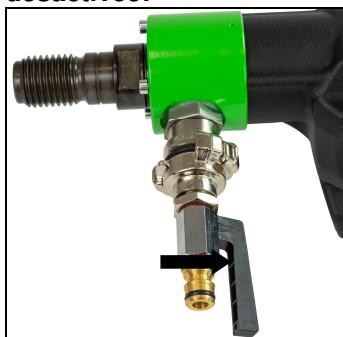
Placez l'adaptateur avec la valve à bille sur le connecteur de l'outil et tournez dans le sens de la flèche jusqu'à l'arrêt. Branchez l'outil au réseau d'eau ou à un réservoir sous pression en utilisant le mamelon bien ajusté.
