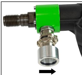
Støv der opstår under kerneboring er sundhedsskadeligt. Derfor skal der anvendes støvsuger, samt bæres støvmaske ved tørboring. Anbring adapteren til støvudsugning på maskinens tilslutning, og drej den i pilens retning for fastlåsning. Våd/tørstøvsugeren samt DSS 35 M iP, kan anbefales som tilbehør. Anvendelsen af støvsuger under tørboring, er også påkrævet for optimal ydelse for diamantkerneboret (Luftkøling).
