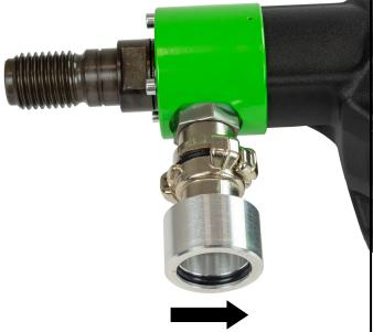
Beim Arbeiten entstehender Staub ist gesundheitsschädlich. Bei Trockenbohrungen ist deshalb ein Staubsauger zu verwenden und eine Staubschutzmaske zu tragen. Setzen Sie den Adapter für die Staubabsaugung auf den Anschluss der Maschine und drehen Sie ihn in Pfeilrichtung gegen den Anschlag. Der passende Nass-Trocken-Sauger DSS 35 M iP ist als Zubehör erhältlich. Die Verwendung einer Absaugung ist ebenfalls Voraussetzung für eine optimale Schnittleistung der Bohrkrone (Luftkühlung).
