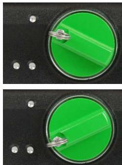
De **ESD 200** is voorzien van een mechanische 2-versnellingen transmissie in olie. Pas de rotatiesnelheid van de motor aan de boordiameter aan (kijk op de type plaatje voor details). Draai de borgbout op de versnellingswisselschakelaar los en draai de versnellingswisselschakelaar zo ver mogelijk in de snellere of langzamere versnelling.
