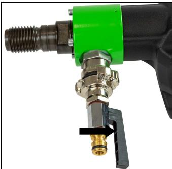
Plaats de adapter met de kogelklep op de connector van het apparaat en draai in de richting van de pijl totdat deze stopt. Sluit het apparaat aan op de watertoevoer of drukvat met behulp van de drukklep.
