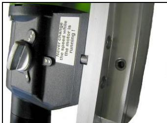
Le support est livré avec une plaque de maintien, un ressort d'ajustage 10 mm et 4 vis à tête creusent M8x25. La plaque de maintien se fixe sur l'outil à l'aide de la clé de telle manière à ce que l'accouplement soit du même coté que du sélecteur de vitesse. Puis insérez et vissez les 4 vis.
