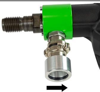
De stof die vrij komt tijdens het gebruik is gevaarlijk voor de gezondheid. Het wordt aanbevolen tijdens gebruik een deduster te gebruiken en een stofmarker te dragen. Plaats de adapter voor de deduster op de connector van het apparaat en draai in de richting van de pijl totdat deze stopt. Een geschikte droog/nat deduster is onze DSS 35 M iP, die als add-on beschikbaar is. Gebruik van een dedusting systeem is ook een vereiste voor optimale prestaties van de boot (luchtgekoeld).
