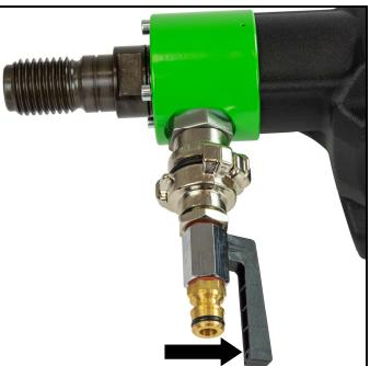
Setzen Sie den Adapter mit dem Kugelhahn auf den Anschluss der Maschine auf und drehen Sie ihn in Pfeilrichtung gegen den Anschlag. Schließen Sie die Maschine über das Stecknippel an die Wasserversorgung oder ein Wasserdruckgefäß an.
