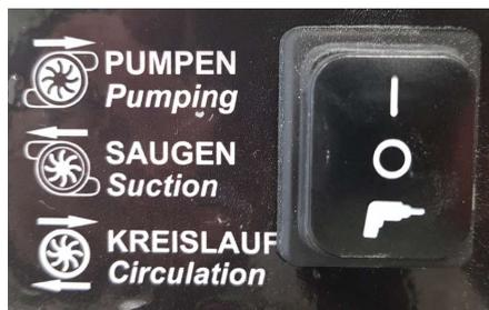
**Pompaggio** – fornitura di acqua alla punta del trapano senza aspirazione, svuotamento dell'unità
