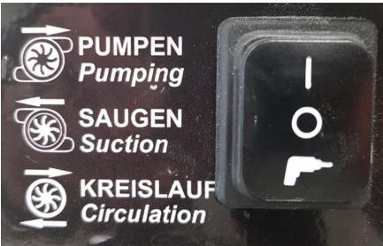
Pumpen – Wasserzuführung an Bohrkronen ohne Absaugung, Entleeren des Gerätes
