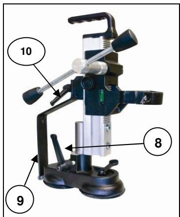
Pour percer dans des niches et des coins, l'affût à colonne pour perforatrice peut pivoter d'un angle maximum de 360°. Pour ce faire, ouvrez l'étau (8), tournez l'affût à colonne pour perforatrice comme voulu puis fermez l'étau. Le support latéral (9) augmente la force de fermeture surtout pour les diamètres de perçage importants.
