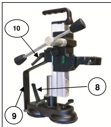
Für Bohrungen in Nischen bzw. Ecken kann die Bohrsäule bis zu 360° geschwenkt werden.
