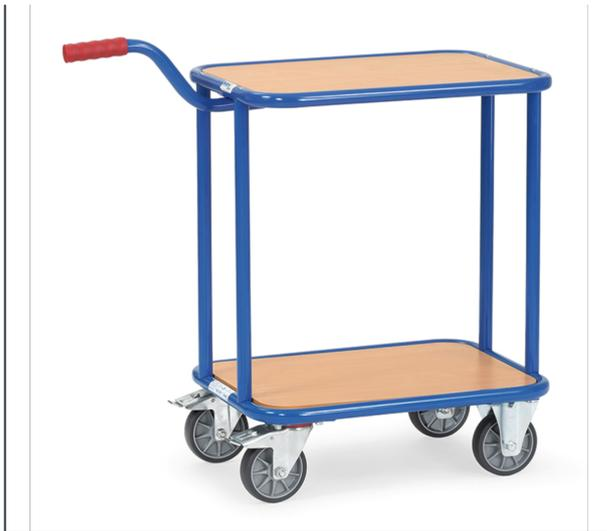
Griffroller aus Stahlrohr geschweißt, pulverbeschichtet brillantblau RAL 5007. Mit Holzplattformen. 2 Plattformen mit im Rahmen liegender Holzwerkstoffplatte, Oberfläche Buchendekor. Griff anschraubbar. 2 Lenk- und 2 Bockrollen, TPE-Bereifung (spurlos), Naben mit Rillenkugellager, Feststeller an den Lenkrollen, gemäß der Europäischen Norm EN 1757-3 (Sicherheit von Plattformwagen). Tragkraft obere Ladefläche 100 kg.
