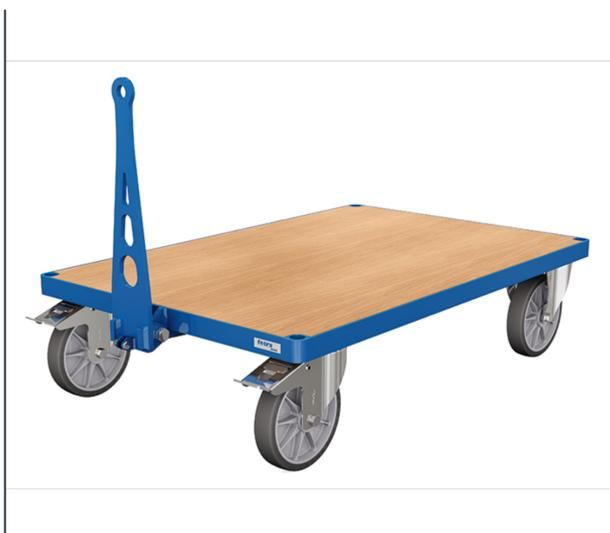
Deichsel und Kupplungszapfen als Zubehör für alle MultiVario-Transporter (600 kg Tragkraft). Für den Transport mit Zugfahrzeugen bis 6 km/h. Züge bis 5 Wagen möglich. Maximales Zuggewicht 2.000 kg. Deichsel aus Flachstahl profiliert, stellt sich mittels Gasdruckfedern selbsttätig in senkrechte Ruheposition. An der Bockrollenseite befindet sich ein stabiler Kupplungsbolzen. Verbindung durch Fußbetätigung möglich.
