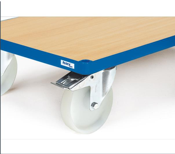
Mehrpreis für Räder mit Polyamid-Bereifung anstelle der Standard-Beräderung. Mehrpreis pro Wagen für Radgröße 125 x 38 mm. Naben mit Rollenlager. Weitgehend beständig gegen Feuchtigkeit, Salz, Säuren und Laugen. Hitzebeständig von -40° bis +90°C.
