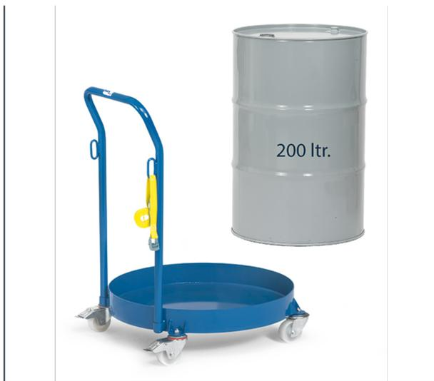
Fassroller für stehenden Transport von 200-Liter Stahlblechfässern. Verschweißte Stahlkonstruktion, pulverbeschichtet brillantblau RAL 5007. Stahlblechwanne, öldicht verschweißt. Innen-Ø 630 mm. Rand 80 mm hoch. Mit anschraubbarem Rohrschiebebügel mit 2 Ösen und 1 Zurring. 4 Lenkrollen, 2 Stück mit Feststeller, Räder Polyamid, Naben mit Gleitlagerung.
