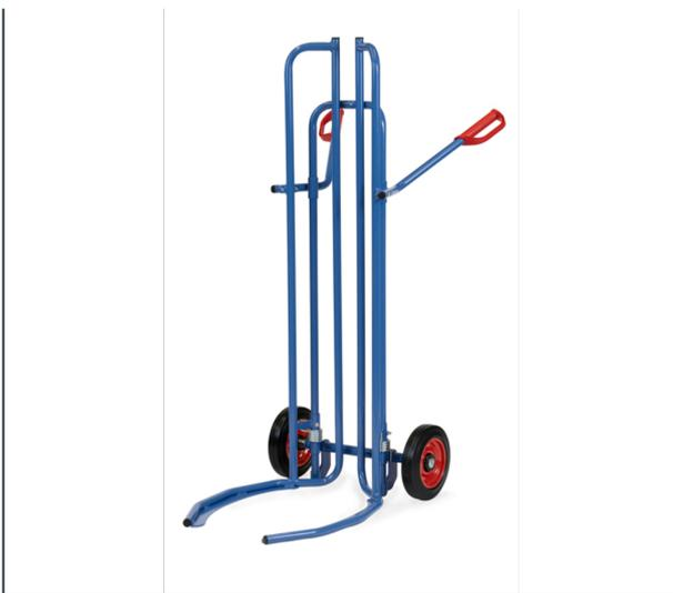
Reifenkarre aus Stahlrohr geschweißt, pulverbeschichtet blau RAL 5007, dauerhaft oberflächengeschützt. Räder mit Vollgummibereifung. Naben mit Rollenlager. Mittels durch die Griffholme zu bedienende Spreiz-Aufnahmen können Reifenstapel direkt aufgenommen oder abgesetzt werden. Geeignet auch für größere wie z.B. SUVs mit Reifen von 450 bis 860 mm Ø. Bis zu 8 Reifen oder Räder möglich.
