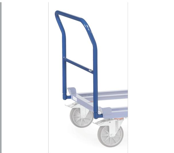
Stabiler Rohrschiebebügel, an der Lenkrollenseite einsteckbar und verschraubbar. Die Einsteckhülsen sind mit dem Fahrgerüst fest verschweißt. Diese Sonderausstattung ist nur zusammen mit den Fahrgerüsten lieferbar, da diese fest verschweißt wird.
