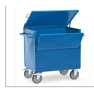
Stahlrohr und Profilstahl geschweißt, pulverbeschichtet blau RAL 5007. Boden aus Stahlblech, pulverbeschichtet. Winkelstahl-Konstruktion. Wände aus gesicktem Stahlblech, eingeschweißt, pulverbeschichtet. Mit einteiligem Deckel, Hochstellung durch Gasdruckfedern. Ringösen für Vorhängeschlösser. 2 Lenk- und 2 Bockrollen, TPE-Bereifung, Naben mit Rillenkugellager. Feststeller an den Lenkrollen, gemäß der Europäischen Norm EN 1757-3 (Sicherheit von Plattformwagen). Nutzhöhe: 816 mm.
